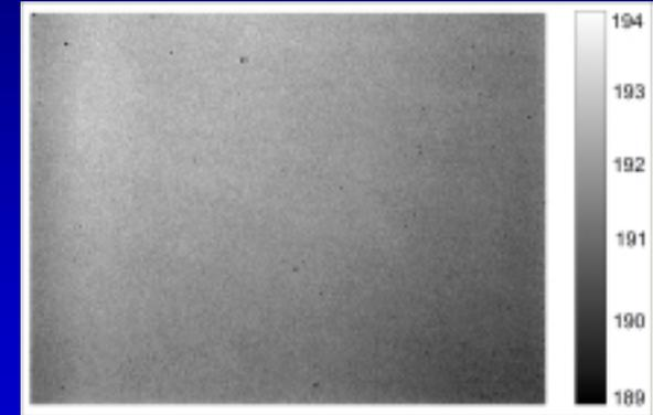
Aufgrund der nicht linearen Empfindlichkeit kann vom Ausgabewert nicht auf die Lichtintensität am CCD-Chip zurückgeschlossen werden!
